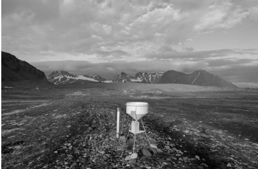
Rys. 3.1.4. Lej zbierający opady atmosferyczne w rejonie Stacji Polarnej Hornsund (foto A. Nawrot). Atmospheric precipitation collecting funnel at Polar Station Hornsund (photo by A. Nawrot).
